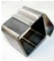
Soudage par impulsion électromagnétique de tôles (aluminium-acier) (Source: PSTproducts)
