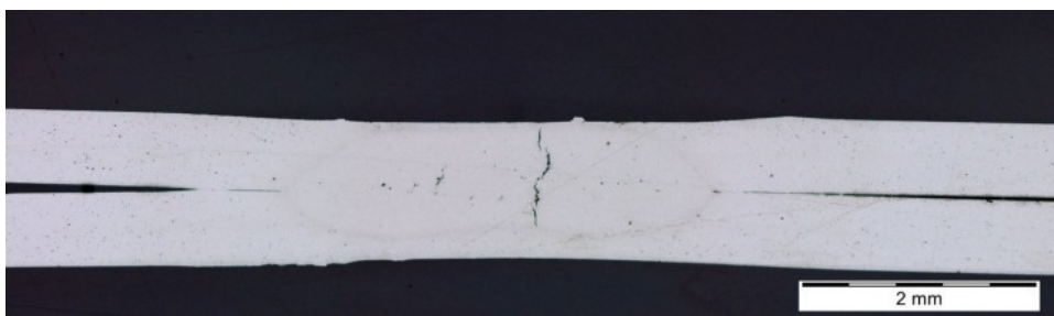
Figuur 6: Doorsnede van een gelast sample - onbehandelde plaatjes (EN AW-7075-T6)
