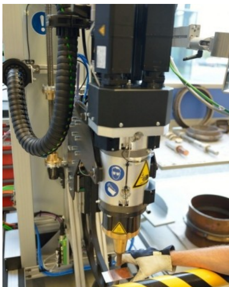
Figuur 2: Wrijvingspuntlasmachine in het Belgisch Instituut voor Lastechniek (B.I.L.)
