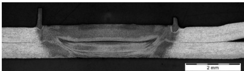
Figuur 4: Voorbeeld van een las in AA7075-T6, mét sealing (geëist)
