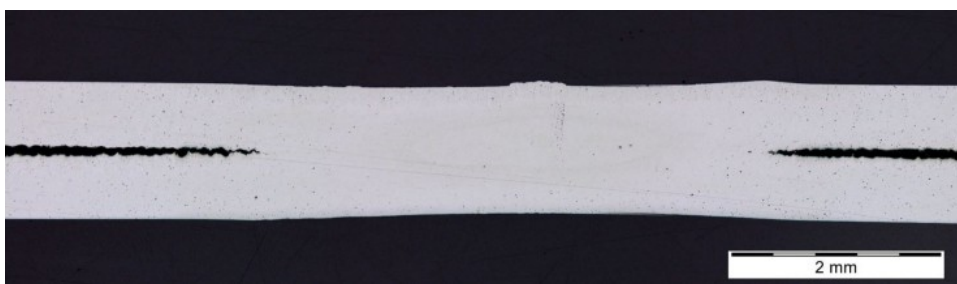
Figuur 7: Doorsnede van een gelast sample - lasergereinigde plaatjes (EN AW-7075-T6)
